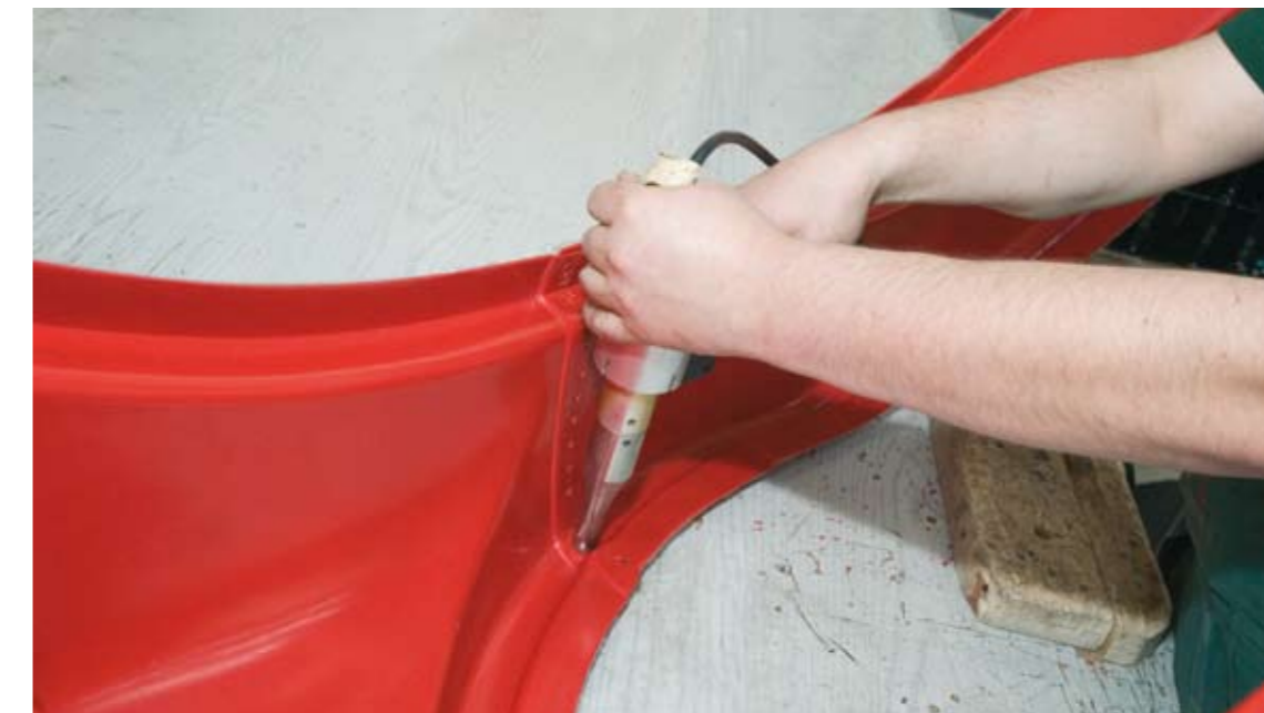
Zgrzewanie elementów błotnika
