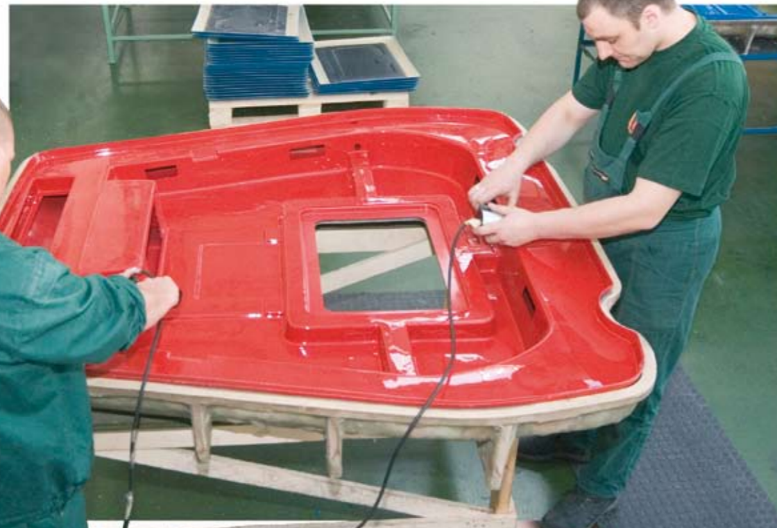
Łączenie części wewnętrznej z zewnętrzną dachu kabiny ciągnika PRONAR
