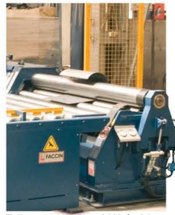
W cyklu automatycznym następują kolejne fazy gięcia...
