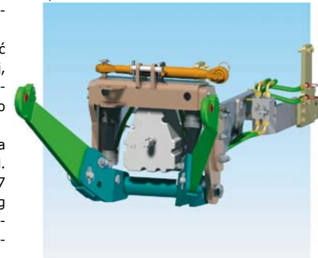
TUZ przedni wyposażony w zawór do sterowania opadaniem ramion
