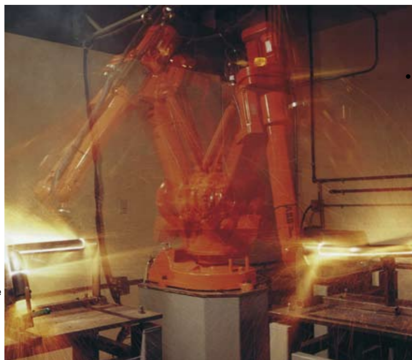
Zdjęcie robota (wykonane przy czasie otwarcia migawki 1/5 s) obsługującego dwa stanowiska. Zarejestrowano dwie skrajne pozycje pracy
