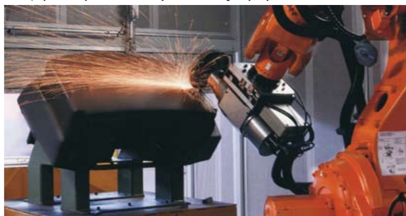
Robot przystosowany do szlifowania i cięcia detali wielkogabarytowych
