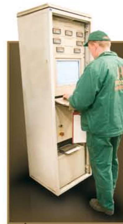
Odczyt, zapis, rejestracja i wydruk wyników badania na komputerze stanowiska diagnostycznego zapewnia specjalny program komputerowy
