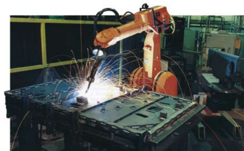
Spawanie „korpusu ściany” maszyny rolniczej przy pomocy uniwersalnego robota
