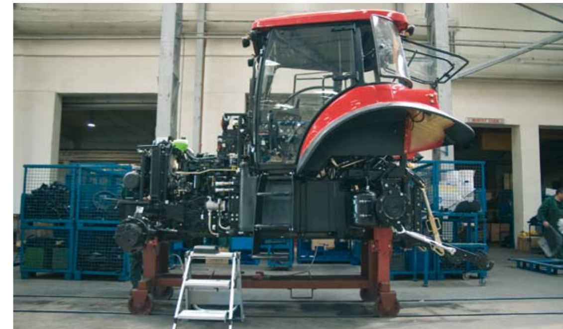
Na linii montażowej wszystko musi do siebie idealnie pasować. Na zdjęciu - ciągnik serii P5 z transmisją, mostem przednim i tylnym, silnikiem i zamontowaną kabiną
