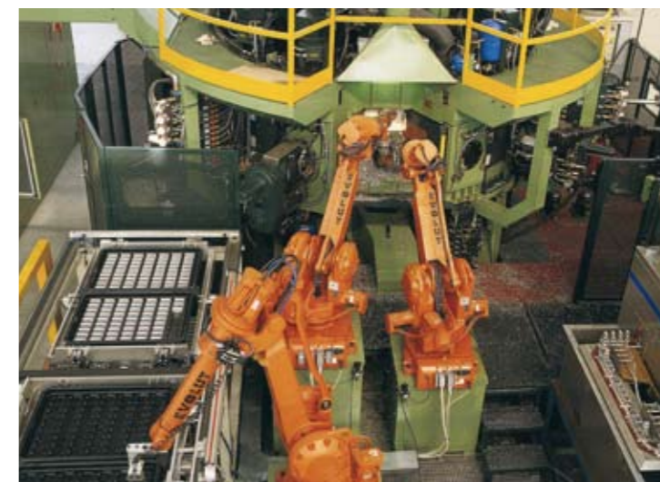
Zespół robotów paletyzujących i transportowych przygotowujących detale do obróbki na obrabiarkach zespołowych sterowanych numerycznie
