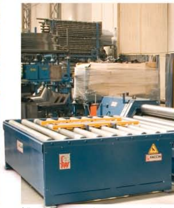
Stół wyposażony jest w system centrowania arkusza blachy. Za pomocą rolek materiał przemieszcza się w stronę walców
